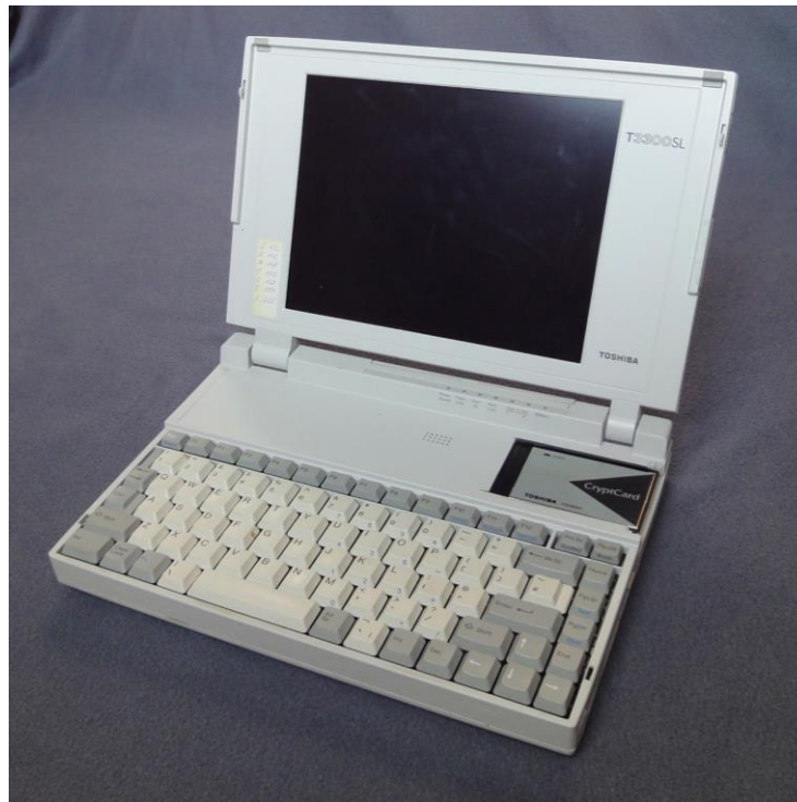
Abb. 4: T3300SL mit der CryptCard im aufgesägten PCMCIA-Schacht
